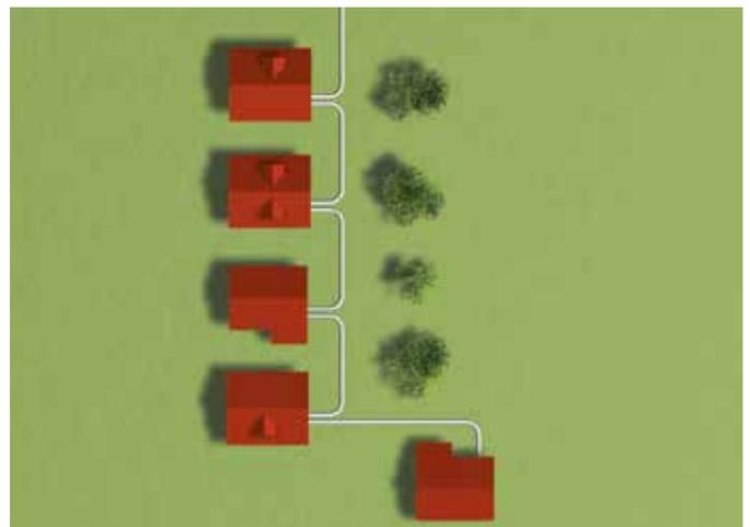
Abb. 23 Einschleifmethode
