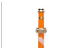
9. Die Klemmringverschraubung für das Rohr RAUTHERM SPEED 16 x 1,5 K mit einem Drehmoment von max. 40 Nm an dem REHAU Heizkreisverteiler anziehen.
