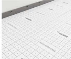
6 Alle Plattenlängs- oder Querkanten sowie der Randdämmstreifen sind verklebt und dichten gegen Estrichanmachwasser und Feuchtigkeit ab. Das Raster zeigt einen Verlegeabstand von 5 cm und Vielfachem.
