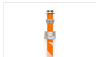
8. Die Klemmringverschraubung für das Rohr RAUTHERM SPEED 14 x 1,5 K bis Anschlag an den REHAU Heizkreisverteiler anziehen.
