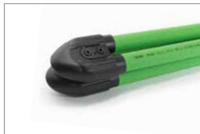
La impulsión y el retorno de la sonda RAUGEO PE-Xa consisten en un tubo continuo, curvado en el pie de la sonda mediante un método de fabricación especial e inyectado en resina de poliéster reforzada con fibra de vidrio, como protección adicional.
