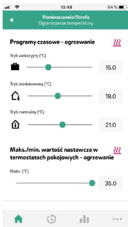
Rys. 08-39 Aplikacja: ustawienia wartości zadanych dla pomieszczenia/strefy
