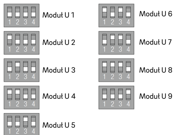
Rys. 07-3 Przełączniki DIP na module U
