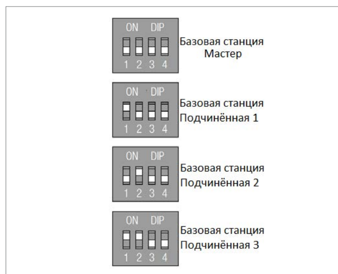
Abb. 7-2 DIP-переключатели на базовой станции
