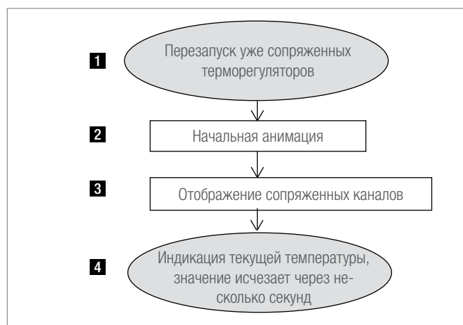
Abb. 7-6 Настройки терморегулятора Nea Smart 2.0
