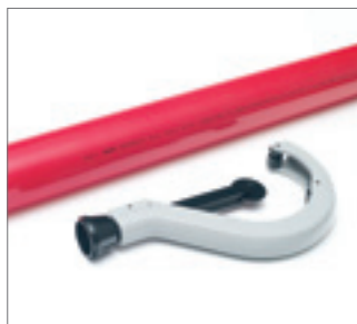
Рис. 89 Отрежьте трубу по размеру под прямым углом
