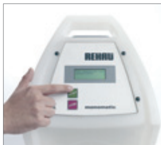
Рис. 103 Повторно нажать на кнопку пуска и запустить процесс сварки
