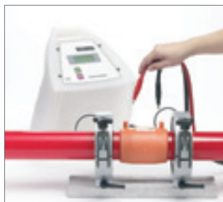
Рис. 104 Звуковой сигнал срабатывает после завершения процесса сварки. На дисплее появляется сообщение «OK». Штекерные разъёмы можно вынуть
