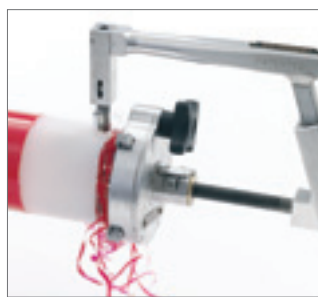
Рис. 93 Производить зачистку трубы дважды
