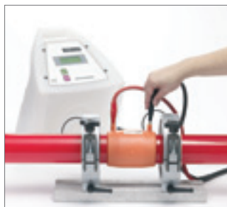
Рис. 100 Подключить сварочный аппарат REHAU, подвести красный кабель к красному контакту. Параметры сварки определяются автоматически
