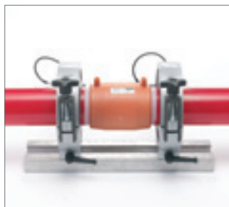
Рис. 99 Подготовить второй конец трубы, полностью вставить в электросварную муфту и закрепить в устройство для фиксации трубы
