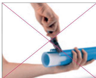
Рис. 69 Не удаляйте верхний слой за пределами отметок
