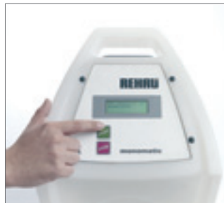
Рис. 58 6. Начать процесс сварки нажатием кнопки «Старт»
