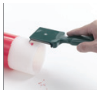
Рис. 94 Остатки краски необходимо полностью удалить шпателем
