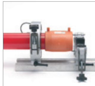
Рис. 98 Устройство для фиксации трубы установить как можно ближе к электросварной муфте FUSAPEX
