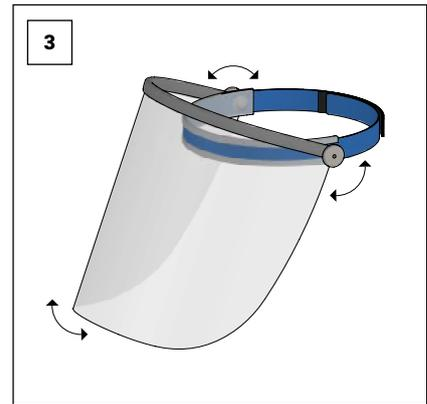
Fixierungsschrauben leicht lösen, Winkel des Schirms einstellen und Fixierungsschrauben wieder fest ziehen.
