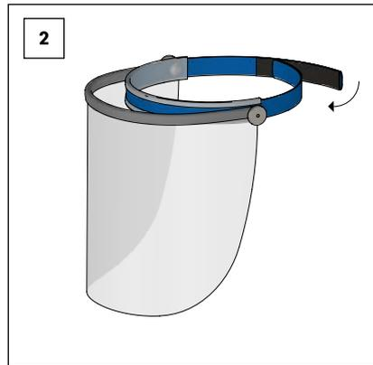
Face Shield am Kopf anlegen und mit Klettband fest verschließen.
