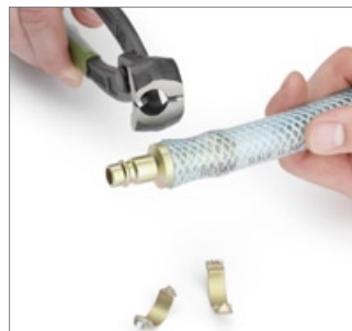
Abb. 22: 2. Aufgeschnittene Zweiohrenklemme fällt selbständig ab.
