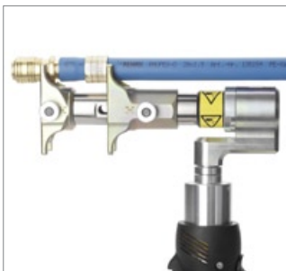
Abb. 31: 5. Werkzeug an der Verbindung ansetzen.
