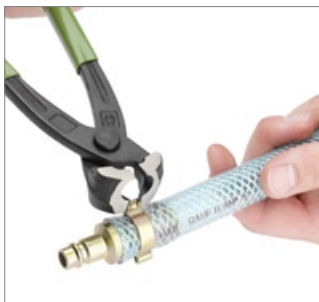
Abb. 21: 1. Mit der Zweiohrenzange die Zweioh- renklemme der Breite nach aufschneiden.
