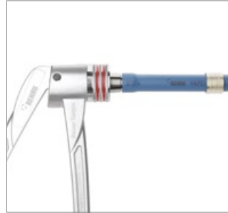
Abb. 29: 3. Rohr zweimal um 30° versetzt mit Aufweitzange (oder Aufweitsatz) aufweiten.
