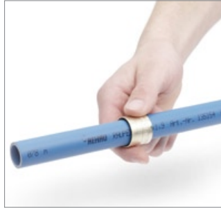
Abb. 28: 2. Schiebehülse über das Rohr schieben. Innere Anfasung muss zum Rohrende zeigen.
