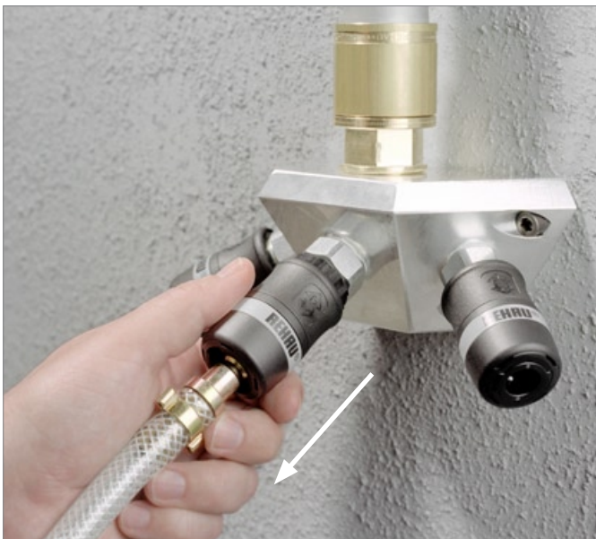
Abb. 5: Lösen des Nippels
