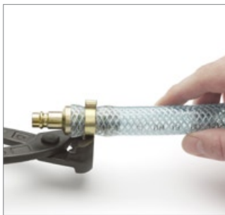
Abb. 19: 5. ...wechselseitig mit der Zweiohrenzan- ge festklemmen.
