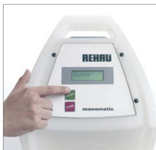
Abb. 50 12. Nochmaliges Drücken des Startknopfes löst den Schweißvorgang aus.
