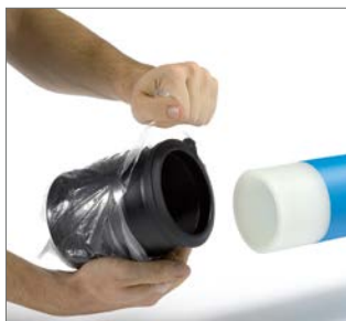
Abb. 44 6. Elektroschweißmuffe erst unmittelbar vor dem Verarbeiten aus dem Beutel entnehmen. Wenn erforderlich Schweißmuffe mit Tangit säubern.
