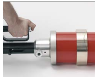
Abb. 28 3. Rohr zweimal um 30° versetzt aufweiten. Aufweitwerkzeug grundsätzlich bis zum Anschlag einstecken und nicht verkanten. Schiebehülse darf sich nicht in der Aufweitzone befinden.
