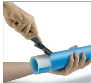
Abb. 41 3. Beschichtung mit Handschaber vollständig entfernen. Nicht über die Markierung hinwegschaben. Der Span sollte eine Dicke von ca. 0,2 mm haben.
