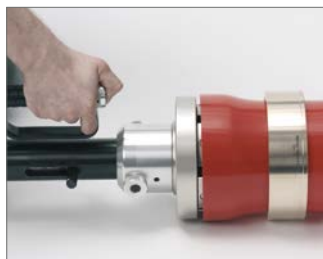
Abb. 29 4. Die Einsteckzeit des Fittings in das Rohr kann durch das Halten des Aufwiedruckes bei voll geöffnetem Aufweitkopf (Endposition beim Aufweitvorgang) beeinflusst werden.
