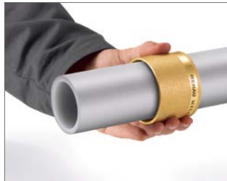
Abb. 18 2. Schiebehülse über das Rohr schieben. Innere Anfasung muss zum Rohrende zeigen.
