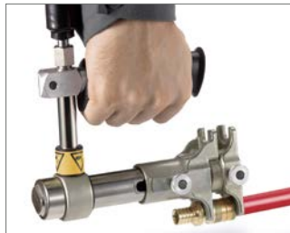
Abb. 16 6. Schiebehülse bis zum Fittingkragen aufschieben. Die Verbindung ist sofort nach Fertigstellung mit Druck und Temperatur belastbar.
