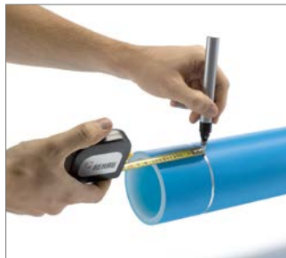
Abb. 40 2. Das Abschabmaß gemäß Tabelle 8 anzeichnen.
