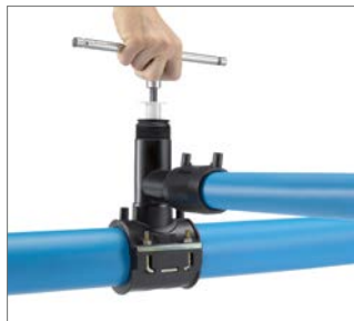
Abb. 61 9. Nach der Druckprobe mit Inbus-schlüssel NW 12 das Locheisen in das Hauptrohr einschrauben
