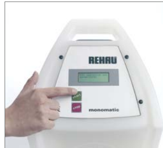
Abb. 58 6. Startknopf des Schweißgeräts drücken und Anweisungen folgen. Schweißparameter im Display mit Werten auf der Anbohrschelle vergleichen.
