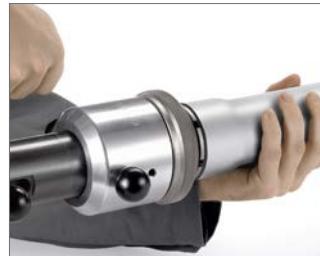
Abb. 19 3. Rohr zweimal um 30° versetzt mit Aufweiteinheit des RAUTOOL G1 aufweiten. Aufweitwerkzeug grundsätzlich bis zum Anschlag einstecken und nicht verkanten. Schiebehülse darf sich nicht in der Aufweitzone befinden.
