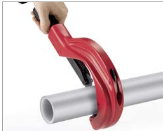
Abb. 17 1. Rohr gratfrei und rechtwinklig auf das gewünschte Maß ablängen.
