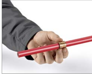
Abb. 12 2. Schiebehülse über das Rohr schieben. Innere Anfasung muss zum Rohrende zeigen.
