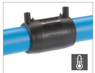
Abb. 80 Die Verarbeitungstemperatur für Rohr, Fitting und Schweißgerät muss zwischen -10\text{ }^{\circ}\text{C} und +46\text{ }^{\circ}\text{C} liegen.
