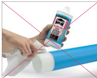
Abb. 74 Keine gebrauchten Lappen zum Reinigen einsetzen. Nur wasserfeste, unbenutzte, nicht eingefärbte oder fasernde und saugfähige Zellstofftücher verwenden.
