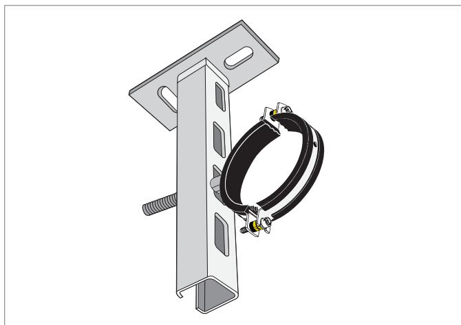
Fig. 3-13 Fast beslag med Uni-stöd
