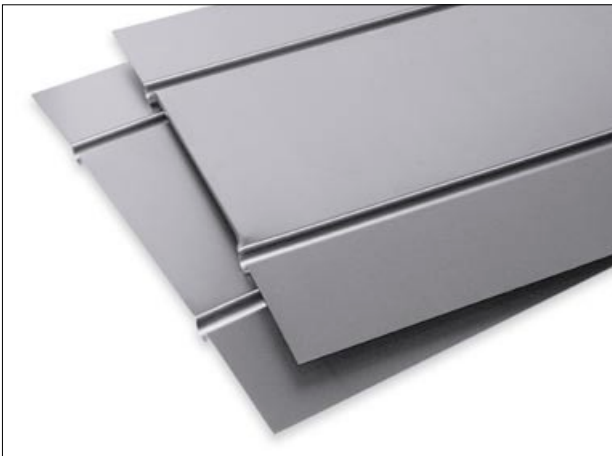
Golvvärmepåsar för träreglar (C/C 600 mm med bockad kant) eller glespanel (C/C 300 mm utan bockad kant). Längd 600 mm, bredd 580 mm. För 20 mm rör med C/C 300 mm.
