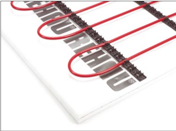
Ingjutning av av RAUTHERM PEX-rör i betong med smart fästprofil (eller buntband) på armering. För 10,1–20 mm rör.
