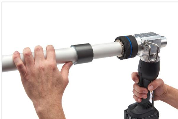
Fig. 11 Bon positionnement des mains pendant l'expansion
