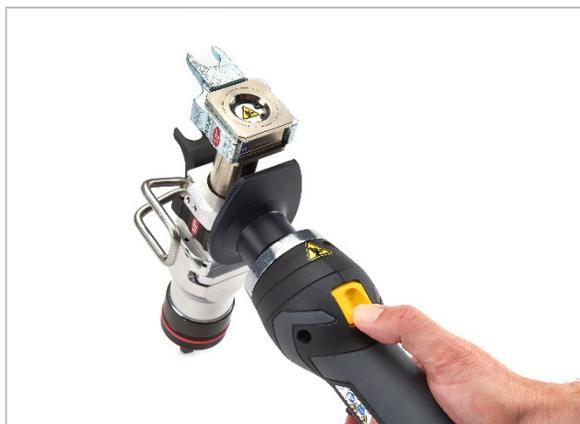
Fig. 2 Appuyez sur le bouton de déverrouillage pour relâcher la pression
