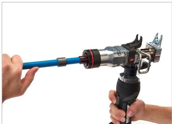
Fig. 3 Bon positionnement des mains pendant l'expansion
