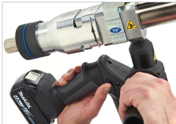
Fig. 6 Appuyez sur le bouton de déverrouillage pour relâcher la pression
