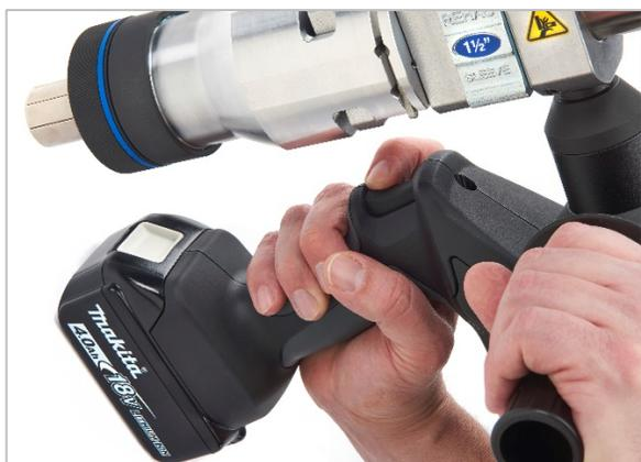
Fig. 5 Utilisez uniquement votre index pour déclencher l'outil hydraulique
