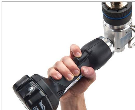
Fig. 10 Appuyez sur le bouton de déverrouillage pour relâcher la pression
