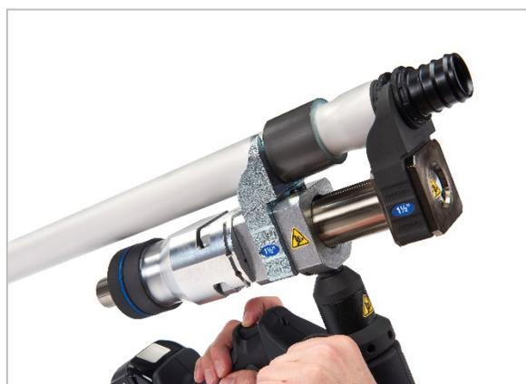
Fig. 8 Bon positionnement des mains pendant la compression
