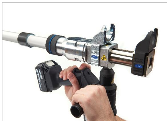
Fig. 7 Bon positionnement des mains pendant l'expansion
