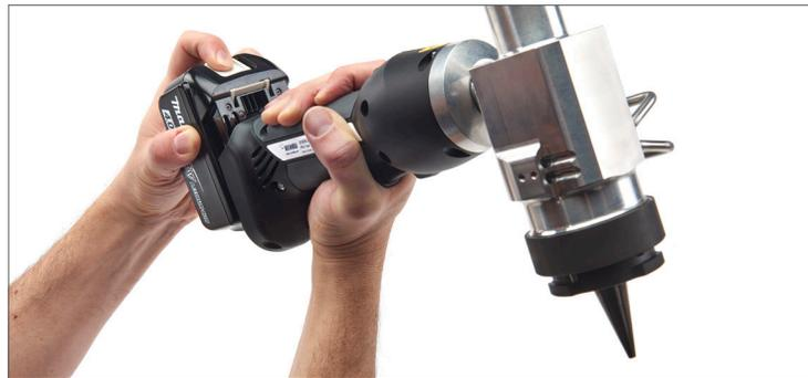
3. Verrouillez la tête d'expansion pour la bloquer en position. Assurez-vous que la tête d'expansion se verrouille avec un déclic audible.
