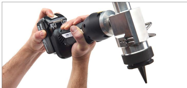
3. Fije el cabezal expensor en su posición. Verifique que el cabezal expensor quede trabado con un clic audible.
