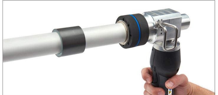
7. Pour relâcher la pression hydraulique et remettre l'outil à sa position initiale, appuyez sur le bouton de déverrouillage.
