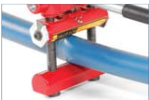
Réarrondissement de la conduite
