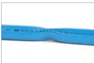
Conduite après l'enlèvement de l'outil
