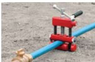
Conduite dans l'outil d'obturation par écrasement
