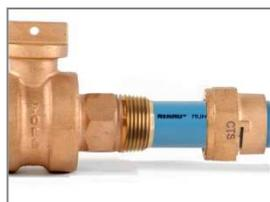
Faire glisser l'écrou de serrage et la bague comprimée du raccord sur le tuyau MUNICIPEX et ensuite insérer complètement le tuyau dans le raccord ou la vanne. S'assurer que le tuyau soit aligné avec le raccord ou la vanne.
