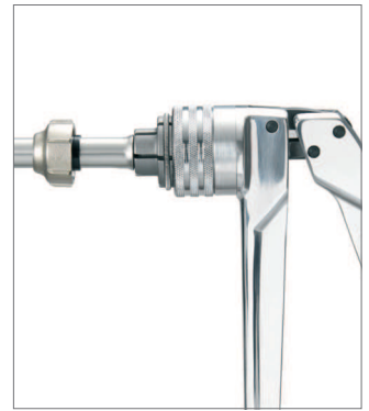
Fig. 13-6 Expandera rörändarna en gång
