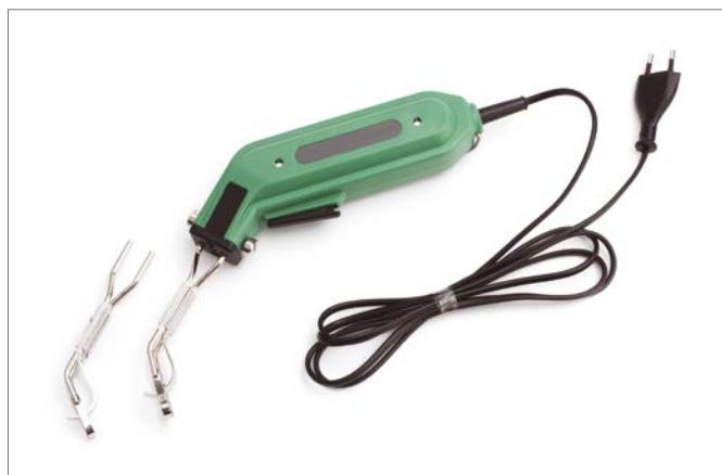
Sl. 4-145 Alat za rezanje žlebova za vođenje cevi
