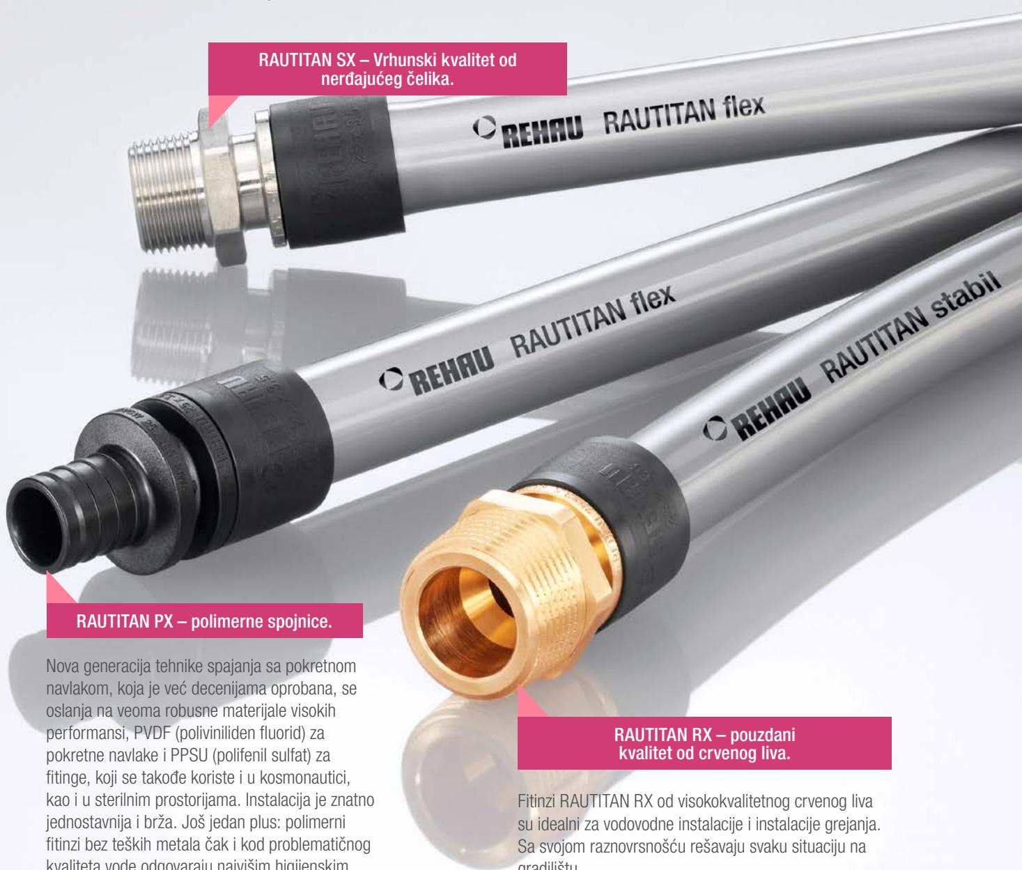
Nova generacija tehnike spajanja sa pokretnom navlakom, koja je već decenijama oprobana, se oslanja na veoma robusne materijale visokih performansi, PVDF (poliviniliden fluorid) za pokretne navlake i PPSU (polifenil sulfat) za fitinge, koji se takođe koriste i u kosmonautici, kao i u sterilnim prostorijama. Instalacija je znatno jednostavnija i brža. Još jedan plus: polimerni fitinzi bez teških metala čak i kod problematičnog kvaliteta vode odgovaraju najvišim higijenskim zahtevima.
