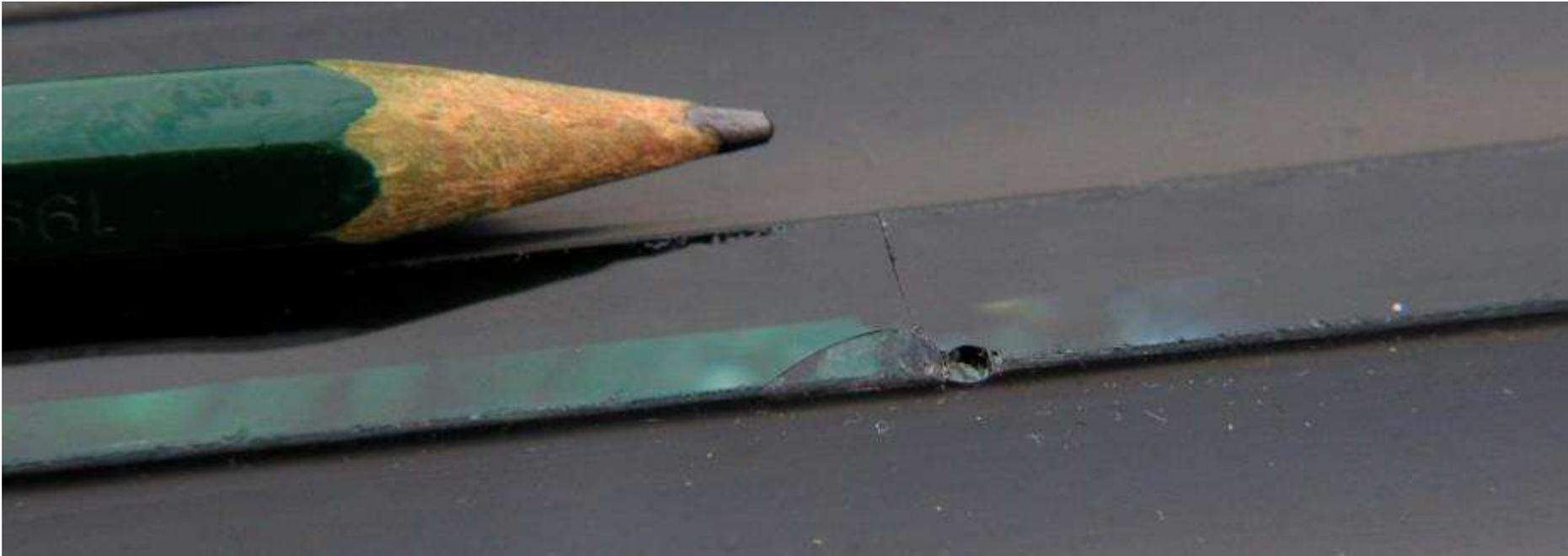
Starke Kantenbeschädigung an der 8 mm Floatglasscheibe
