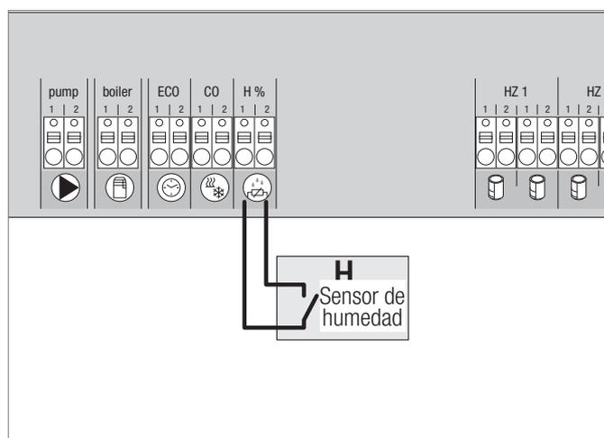
Fig. 3-5 Conexión sensor de humedad
