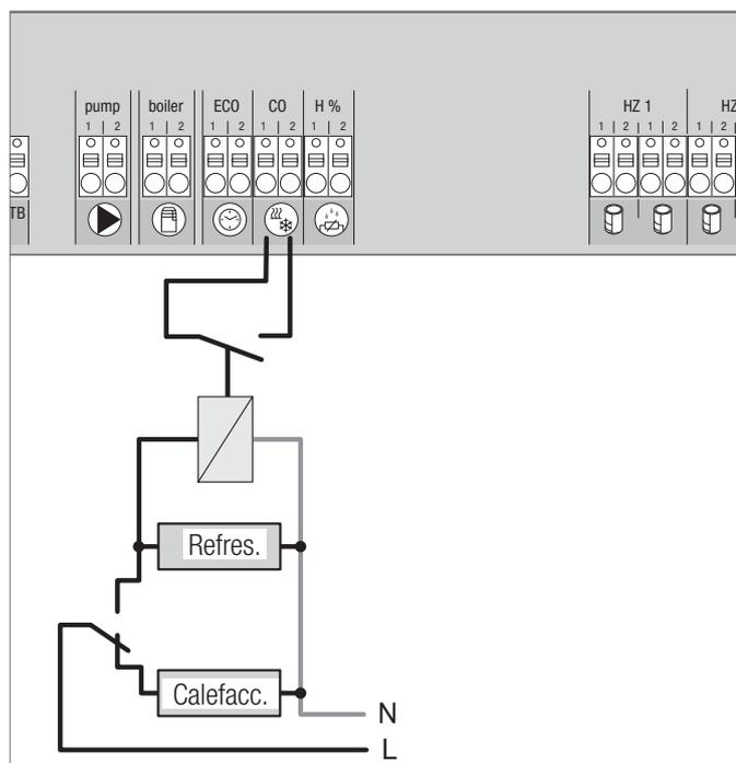
Fig. 3-3 Señal externa de Change Over (conmutación)
