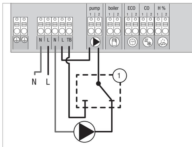
Fig. 3-9 Conexión de un limitador de seguridad de temperatura
