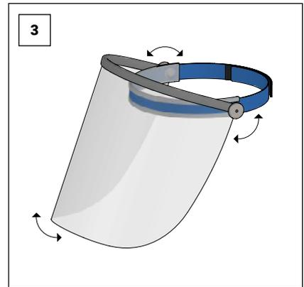
Allentare leggermente le viti di fissaggio, regolare l'angolo della visiera e serrare nuovamente le viti.
