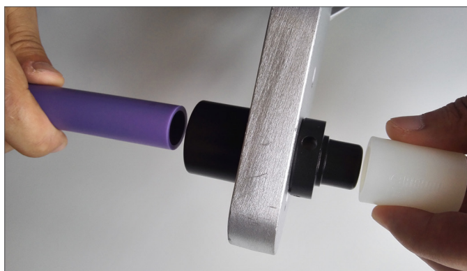
图 8-9 加热管道和管件
