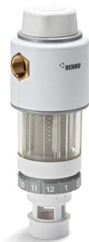
RE.FINE Pure è un dispositivo di filtrazione meccanica dotato di rete filtrante con grado di filtrazione pari a 89 micron progettato per il trattamento di acqua potabile. Il filtro protegge l'impianto di distribuzione dell'acqua e le condotte dai danni provocati da ridotte quantità di impurità quali sassolini, scaglie di ruggine e altri tipi di ossidi, sfridi metallici di dimensione massima pari a 2 mm.
