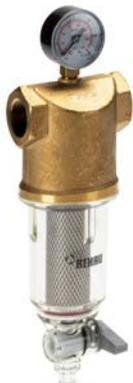
RE.FINE Select è un dispositivo di filtrazione meccanica dotato di rete filtrante con grado di filtrazione pari a 89 micron progettato per il trattamento di acqua potabile. Il filtro protegge l'impianto di distribuzione dell'acqua e le condotte dai danni provocati da ridotte quantità di impurità quali sassolini, scaglie di ruggine e altri tipi di ossidi, sfridi metallici di dimensione massima pari a 2 mm.
