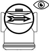
3. Avvitare RE.FINE Select. Stringere i collegamenti a vite con un attrezzo adeguato (chiave normale o regolabile). La filettatura del filtro è conforme alla norma UNI EN 10226-1.
