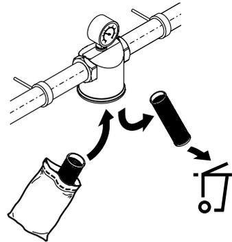
Controllare lo stato dell'O-ring del vaso del filtro e sostituire come necessario.
