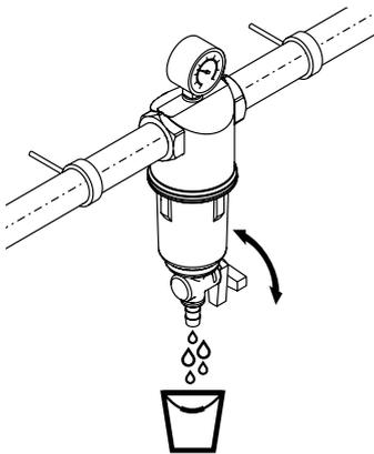
3. Svitare il vaso del filtro utilizzando la chiave fornita in dotazione.
