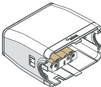
Вставьте отсек для батареек с батарейками по предусмотренной для него направляющей в верхней части корпуса. Для этого слегка поднимите/наклоните отсек для батареек, чтобы провести его мимо скоб крепления. Зафиксируйте отсек для батареек и проверьте надежность его удержания скобами.
