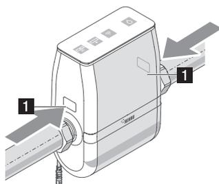
Слегка нажмите на клавиши **1** фиксации над штуцерами блока контроля воды системы RE.GUARD для подсоединения к водопроводу (максимум на 5 мм).
