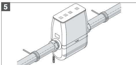
Установите плоские уплотнения и наживите накидные гайки на резьбовые штуцеры блока контроля воды RE.GUARD. Затяните резьбовые соединения с помощью соответствующего инструмента, например вилочного или разводного ключа (требуемый размер ключа для системы RE.GUARD – 27).
