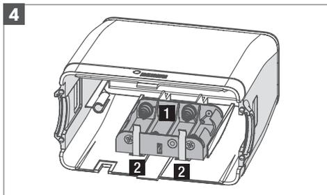
Наклоните верхнюю часть корпуса и достаньте отсек для батареек **1** по направляющей в верхней части корпуса, чуть-чуть подняв/наклонив его и мягко прижав к скобам крепления **2**.
