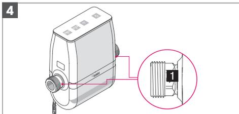
Установите блок контроля воды RE.GUARD. Если необходимо повернуть дисплей, см. указания в разделе «3.5 Поворот верхней части корпуса», стр. 26.
