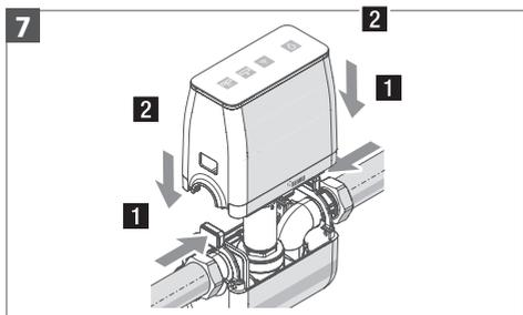
Выровняйте верхнюю часть корпуса и с нажатыми клавишами фиксации установите на нижнюю часть.
