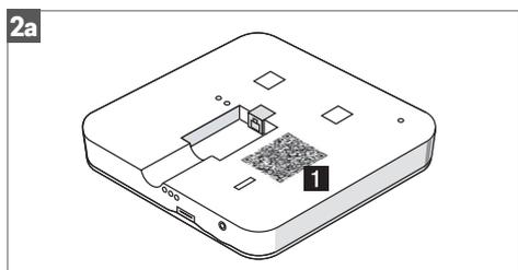
Когда появится соответствующий запрос, отсканируйте QR-код сетевого шлюза RE.HUB: отсканируйте QR-код **1** на задней панели сетевого шлюза RE.HUB.
