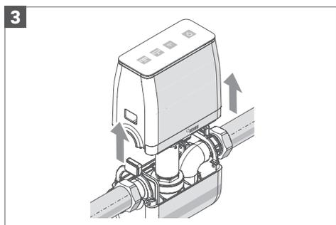
Не отпуская клавиши разблокировки, осторожно снимите верхнюю часть корпуса. Следите, чтобы ширина зазора между верхней и нижней частями не превышала примерно 10 см.
