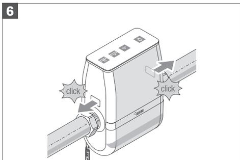
Продолжайте опускать верхнюю часть до слышимого и осязаемого входа клавиш разблокировки в зацепление с соответствующими углублениями.
