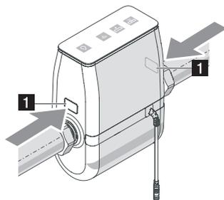
Слегка нажмите на клавиши разблокировки над штуцерами блока контроля воды RE.GUARD для подсоединения к водопроводу (максимум на 5 мм). **1**
