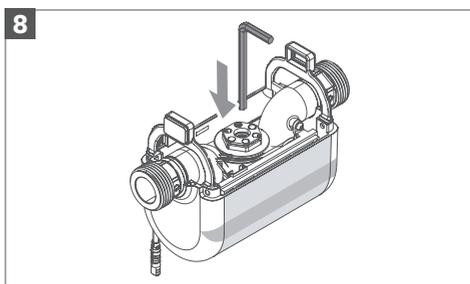
Вставьте торцевой шестигранный ключ в крепление, в которое был вставлен привод.
