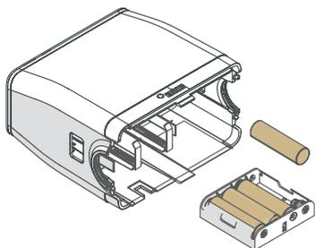
Вставьте в отсек для батареек четыре новые батарейки типа AA (R6). Проверьте полярность: контакты батареек со знаком «минус» должны находиться со стороны контактных пружин. Если на батарейках есть защитная пленка, снимите ее, прежде чем вставлять батарейки.
