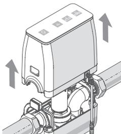
Не отпуская клавиши разблокировки, осторожно снимите верхнюю часть корпуса. Следите, чтобы ширина зазора между верхней и нижней частями не превышала 10 см.
