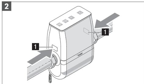
Слегка нажмите на клавиши **1** разблокировки над штуцерами системы RE.GUARD для подсоединения к водопроводу (максимум на 5 мм).
