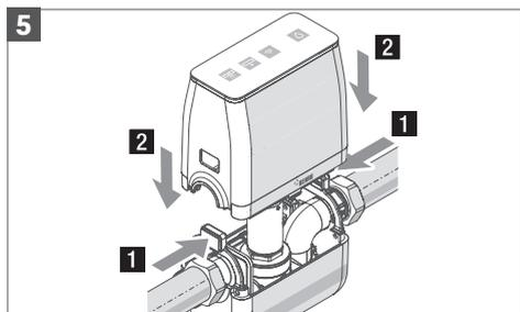
Выровняйте верхнюю часть корпуса и с нажатыми клавишами разблокировки установите на нижнюю часть.
