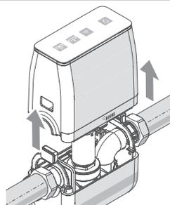
Не отпуская клавиши фиксации, осторожно снимите верхнюю часть корпуса. Следите, чтобы ширина зазора между верхней и нижней частями не превышала примерно 10 см.
