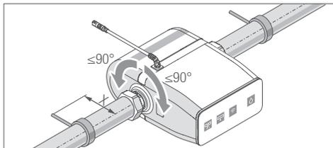
Рис. 3-6 Горизонтальное положение с поворотом до 90°
