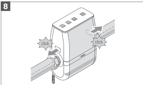
Продолжайте опускать верхнюю часть до слышимого и ощутимого входа клавиш фиксации в зацепление с соответствующими углублениями.
