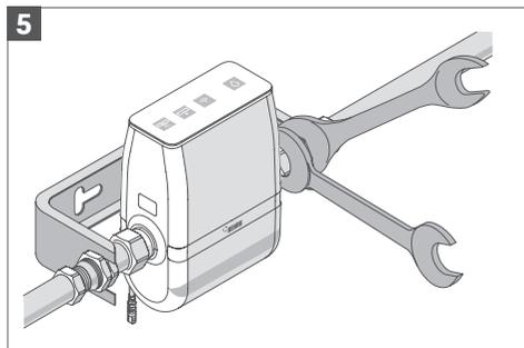
Установите плоские уплотнения и наживите накидную гайку на резьбовых штуцерах блока контроля воды RE.GUARD. Затяните резьбовые соединения с помощью соответствующего инструмента, например вилочного или разводного ключа (требуемый размер ключа для системы RE.GUARD – 27).
