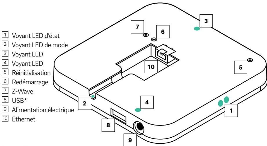
La passerelle dispose de quatre touches sur la partie inférieure du boîtier :
