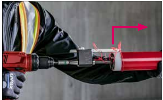
Fig. 03-36 SMARTFUSE DUO 25-75: Il processo di raschiatura inizia all'estremità del tubo.
