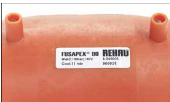
Fig. 03-17 Durante il tempo di raffreddamento indicato sul manicotto non caricare il collegamento in modo meccanico. Nel caso in cui i tubi abbiano tensioni (fornitura in rotoli), è necessario rispettare i tempi di raffreddamento previsti nella tabella 03-4 prima di togliere i morsetti di fissaggio.
