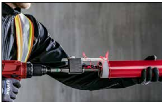
Fig. 03-4 Azionare lo scortecciatore a rotazione con una velocità uniforme alta, si produce un truciolo continuo. Altrimenti, controllare la lama di taglio e regolare la velocità.
