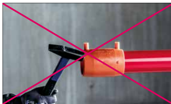
Fig. 03-23 Non forzare l'inserimento del manicotto elettrosaldabile.
