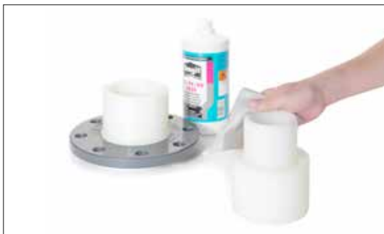
Fig. 03-31 Le flange e le riduzioni non devono essere scortecciate, ma pulite in ogni caso. Il diametro minimo secondo la tab 03-3 deve essere sempre rispettato.
