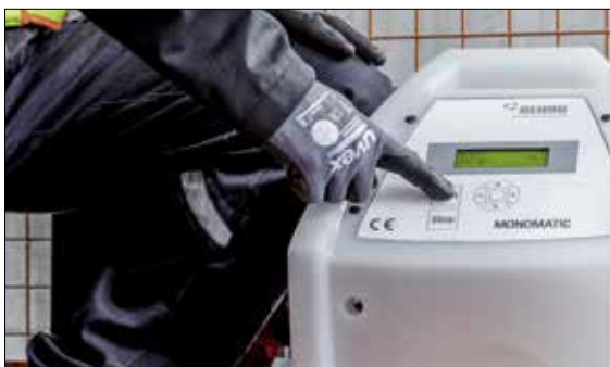
Fig. 03-15 Controllare i parametri di saldatura sul display e confermare premendo il pulsante di avvio. Confermando nuovamente sul display si avvia il processo di saldatura.
