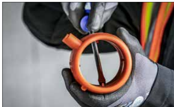
Fig. 03-34 Nel caso in cui il manicotto non venga utilizzato come manicotto scorrevole è opportuno togliere con attenzione i perni di arresto.
