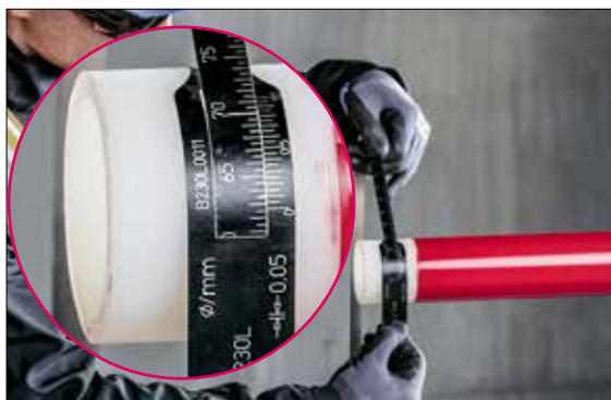
Fig. 03-6 Il diametro esterno minimo ammissibile deve essere rispettato (secondo la tab. 03-3).
