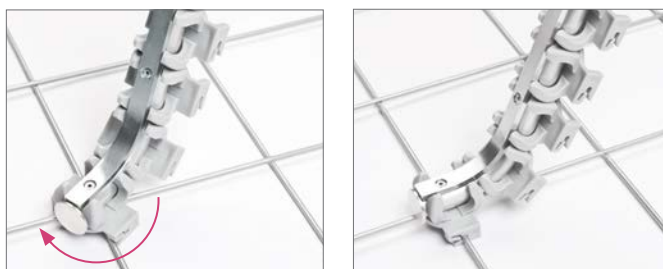
Rys. 4-107 Ustawić przyrząd montażowy z założonym magazynkiem klipsów
