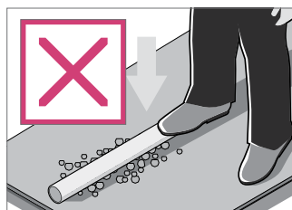
Rys. 3-9 Rury należy chronić przed uszkodzeniami mechanicznymi.
