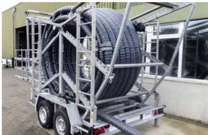
Fig. 3-34 Dérouleur vertical sur une remorque.
