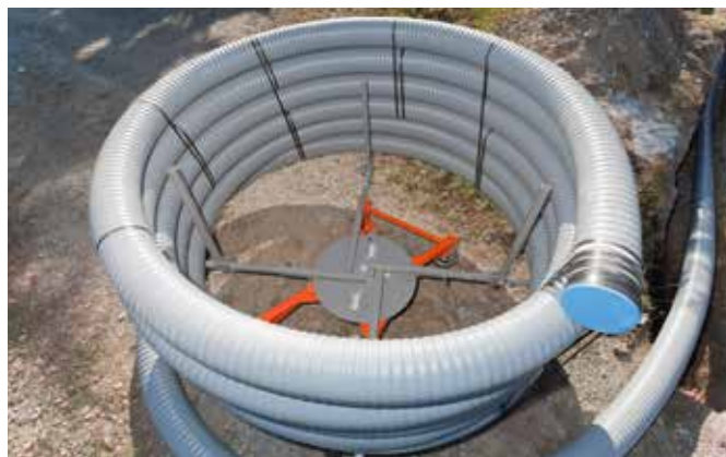
Fig. 3-33 Dérouleur horizontal fixe avec couronne.
