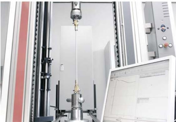
Abb. 03-7 Zugversuch
