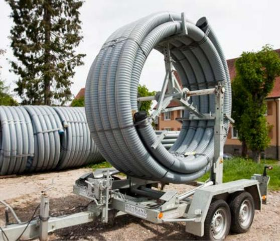
Abb. 07-36 Vertikale mobile Abwickelvorrichtung
