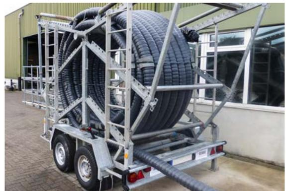
Abb. 07-35 Vertikale mobile Abwickelvorrichtung
