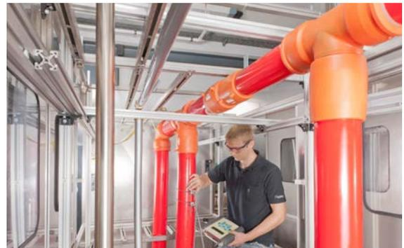
Abb. 06-21 Rohre und Verbindungstechnik werden als System geprüft
