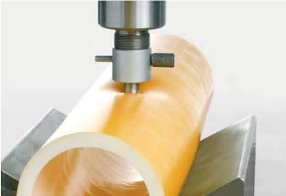
Abb. 03-6 Punktlastprüfung
