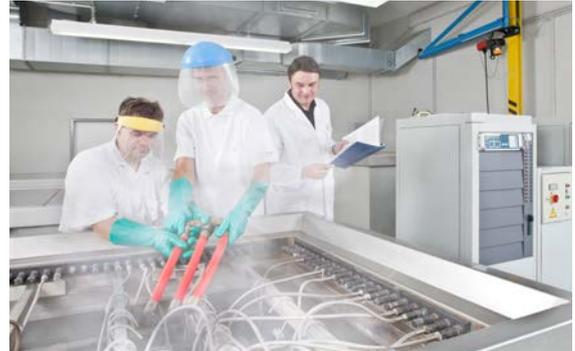
Abb. 06-20 Im Langzeittest werden die Rohre auf ihre Temperatur- und Druckbeständigkeit untersucht
