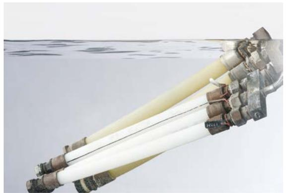
Abb. 03-9 Zeitstandsinnendruckprüfung
