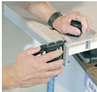
Cortadora REHAU para retestado de cantos – La solución patentada de REHAU para un corte preciso de los cantos.
