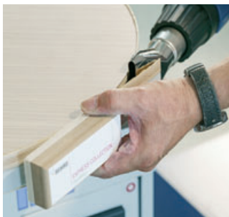
Filtro para pulir y pistola de aire caliente de REHAU – para el acabado de la unión solapada.
