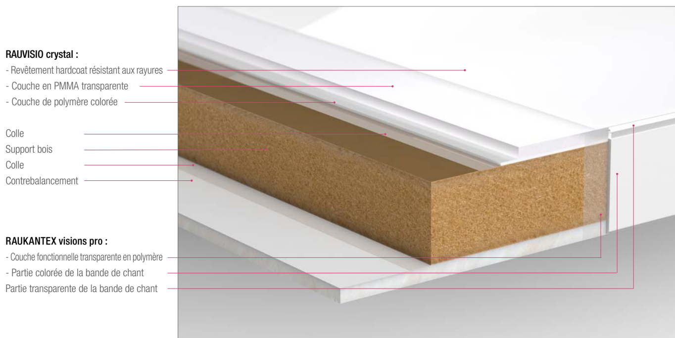
Illustr. 2-2 Système composite RAUVISIO crystal avec chant RAUKANTEX visions pro
