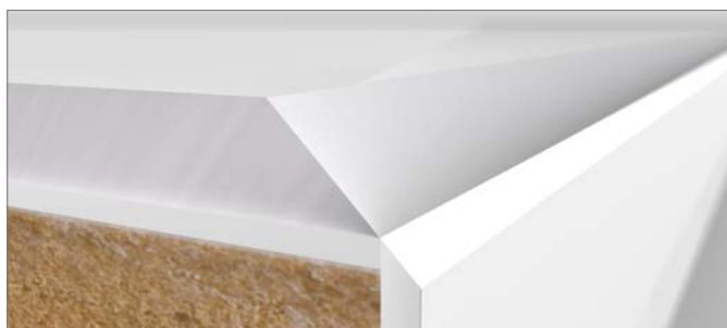
Illustr. 10-20 Chanfrein de 45° sur la bande de chant et la surface
