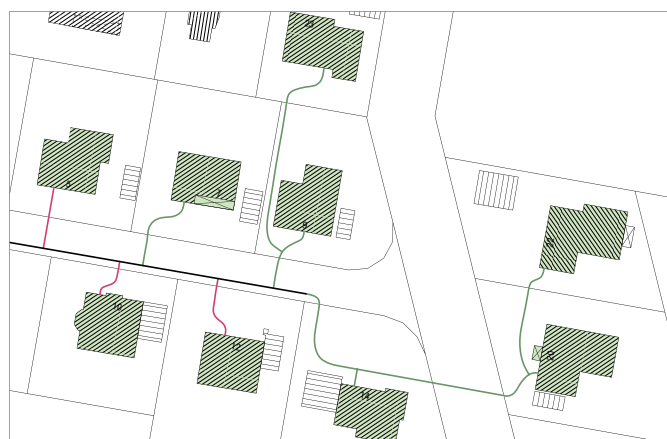
Rys. 6-6 Połączenie różnych systemów rur
