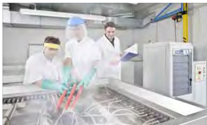
Rys. 6-18 Szczelność rur badana jest w teście długotrwałym
