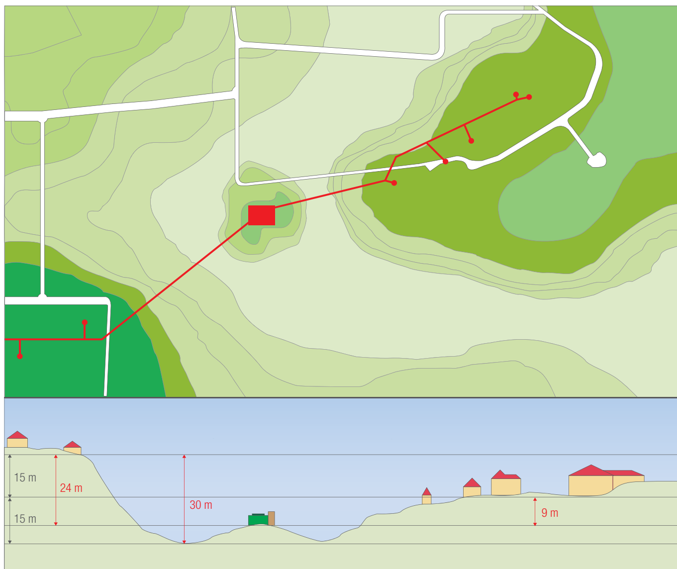
Rys. 6-14 Przykład profilu wysokościowego sieci ciepłowniczej
