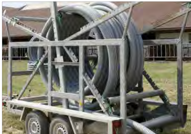
Rys. 7-6 Wózek do odwijania zwojów
