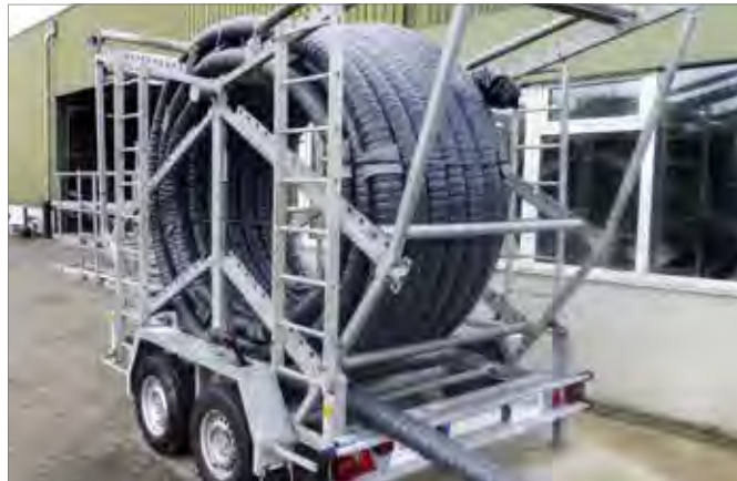
Rys. 7-30 Kołowrót do odwijania rur w pionie
